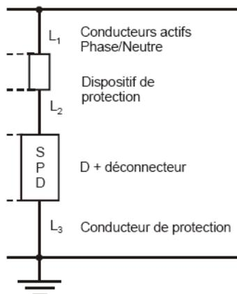
**Figure 10 : Principe de câblage d'un parafoudre**
