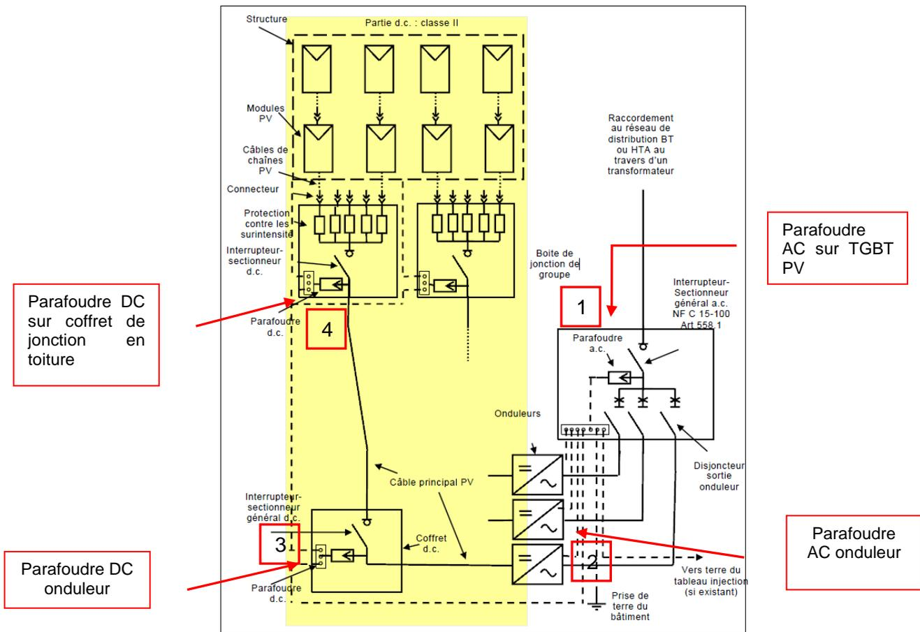
**Figure 8 : Implantation des parafoudres sur l'installation PV. (UTE 15-712)**
