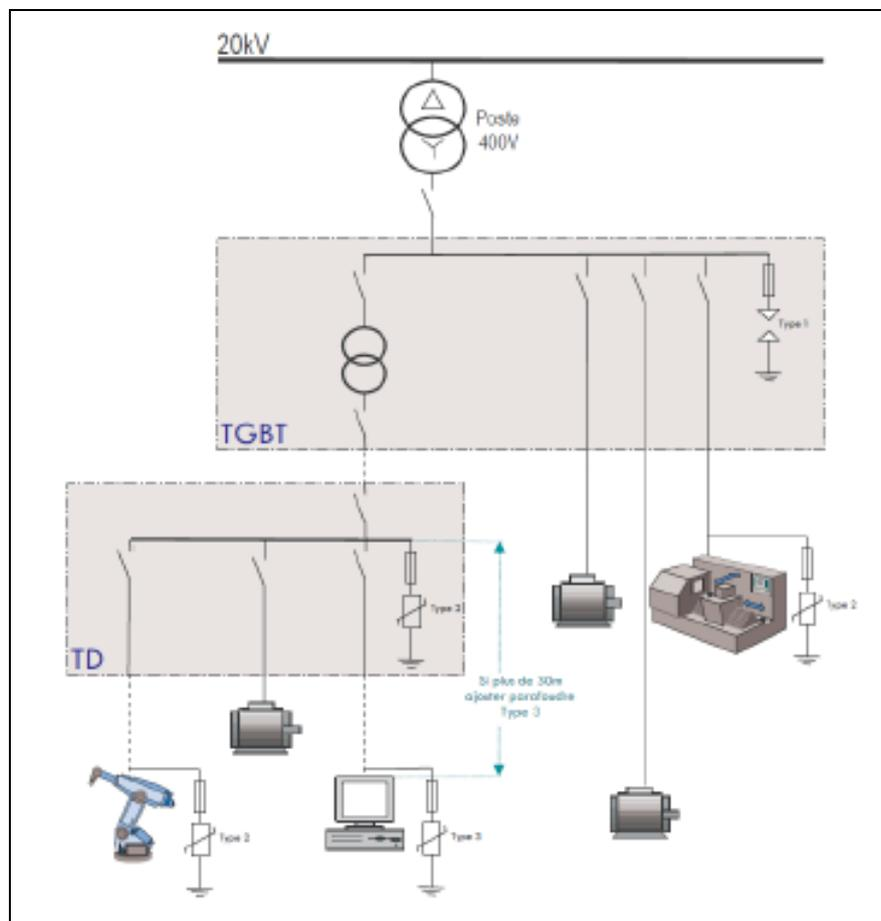
**Figure 7 : Principe de protection par parafoudres**
