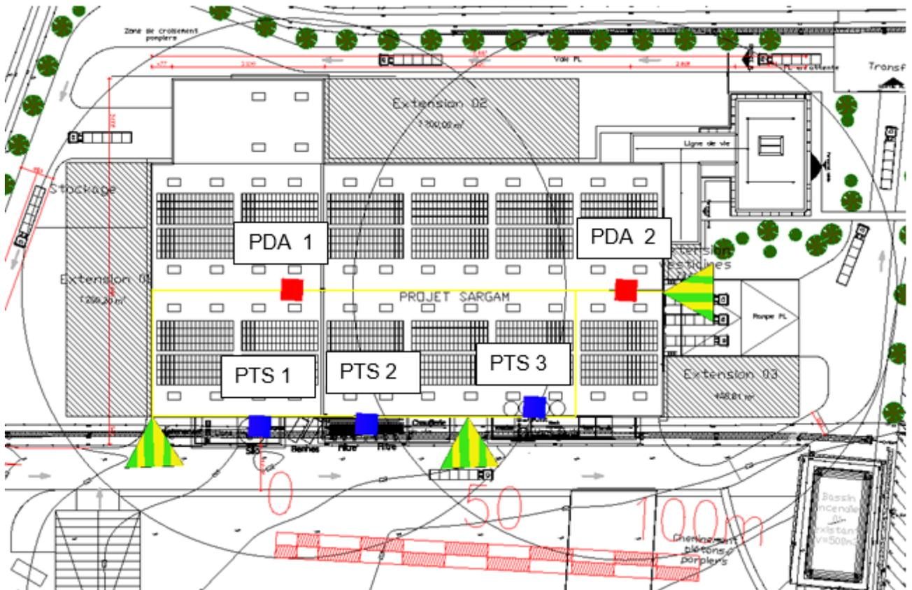
**Figure 12 : Implantation des paratonnerres**
